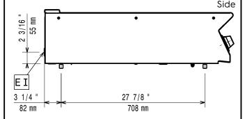
Electrical inlet (power) Equipotential screw
